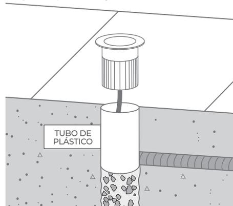
**ATENÇÃO:** na instalação de embutidos de solo em áreas externas, um sistema de drenagem adequado deve ser preparado para ajudar no escoamento de água. A não utilização do tubo de plástico e de uma drenagem eficiente podem resultar em penetração de água e na má dilatação do produto, podendo levar a curto-circuito, quebra, deformação ou sobreaquecimento, sendo estas responsabilidades do cliente.
