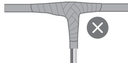
**ATENÇÃO:** a má isolamento com fita, deixando áreas do fio expostas, resultará na entrada de água e, conseqüentemente, em risco de falhas do produto e na segurança, sendo de responsabilidade do cliente.
